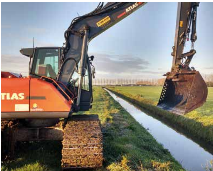
De vaste bak en de maaikorf zijn de meest door waterschappen gebruikte methoden om te baggeren en schonen. (Foto's: Arthur de Bruin)
