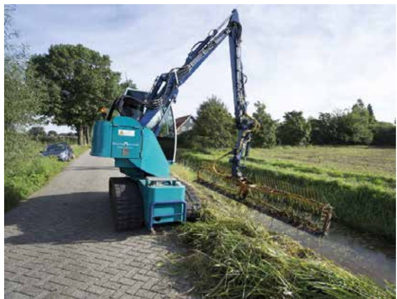
De vaste bak en de maaikorf zijn de meest door waterschappen gebruikte methoden om te baggeren en schonen. (Foto's: Arthur de Bruin)
